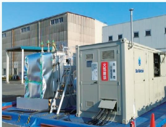
変圧器の屋外での洗浄処理
