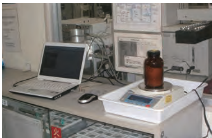
使用試薬の計量管理の模様 (計量値を自動的にパソコンに取り込む)
