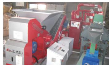
廃電線処理 (銅回収) 装置
