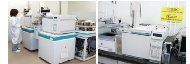
高分解能ガスクロマトグラフ質量分析装置
