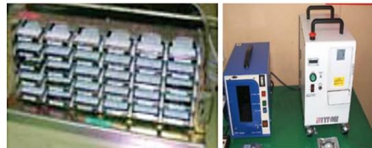
HDD磁気記録媒体の情報消去装置
