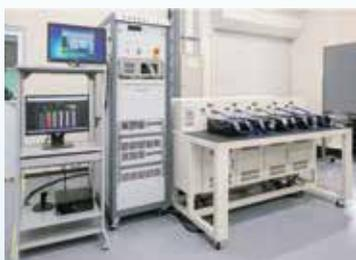
太陽電池モジュール評価設備
