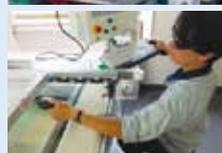
使用済み太陽電池モジュールの性能評価、診断システム開発
