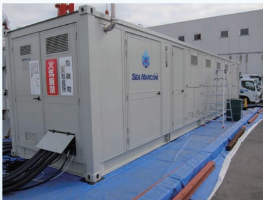
トランスに接続しPCB分解・部材洗浄を行うDMU
