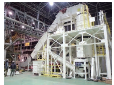
チェーン式破碎機の外観
