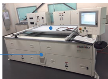
ソーラーシミュレータの外観
