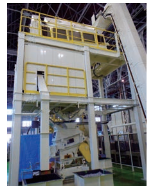
ミックスメタル破碎機・選別機の外観
