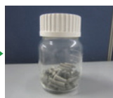
造粒後の固形燃料(ペレット) 約1/4に減容
