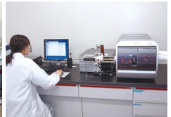
IAMSによる 臭素系難燃剤迅速分析 IAMS:イオン付着質量分析装置
