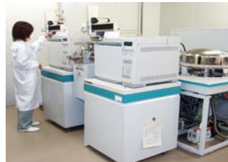
GC/HRMSによる 極微量の測定・定量 GC/HRMS:高分解能ガスクロマトグラフ質量分析装置
